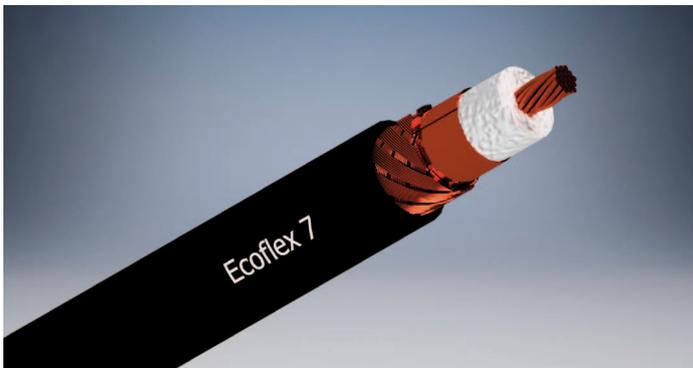
Ecoflex 7 ist ein hochflexibles und extrem dämpfungsarmes Koaxialkabel für den Frequenzbereich bis 6 GHz. Wie die anderen Koaxialkabel der Ecoflex-Familie hat Ecoflex 7 einen Litzeninnenleiter. Dieser besteht aus 19 Litzensträngen aus sauerstoffarmem Kupfer mit einem Durchmesser von je 0,38 mm. Diese Struktur des Innenleiters sorgt für die hohe Flexibilität des Kabels.
