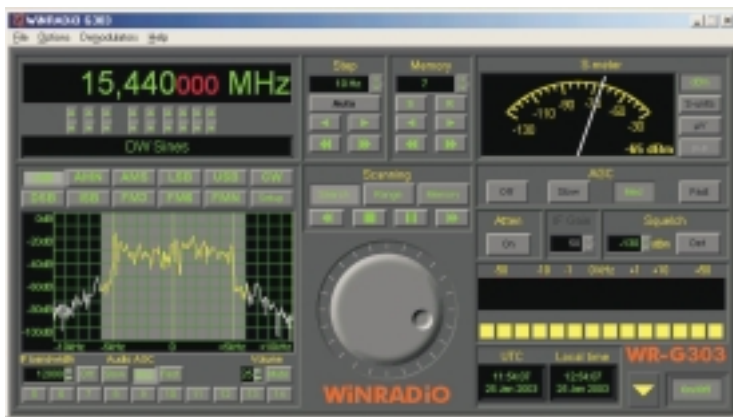
Ein DRM-Signal der Deutschen Welle auf 15440 kHz
