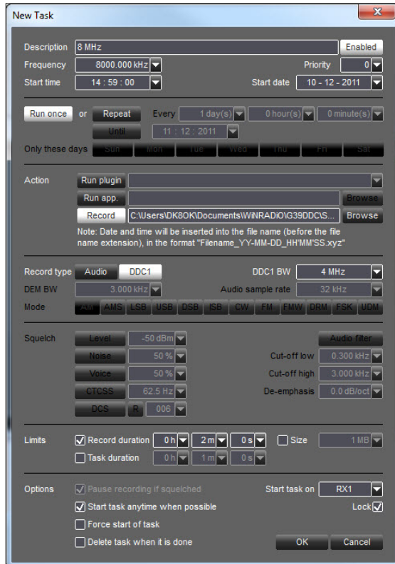
Abb. 6: Fast nur durch Klicken lassen sich sehr unterschiedliche Aufnahmen des Excelsior programmieren. So kann man Start- und Stoppzeiten, Wiederholungen und sogar den Start weiterer Software – wie Decoder – aktivieren.
