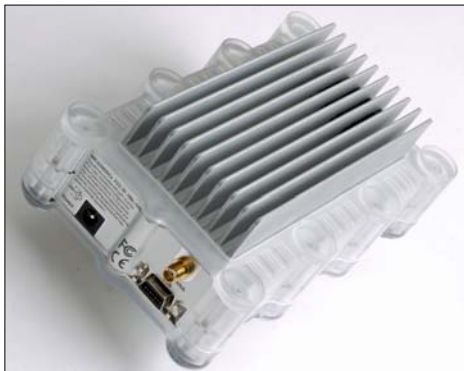
Abb. 18 zeigt den Receiver. Es gibt nur einen Antennenanschluss (SMA-Norm), und die Kühlrippen werden durch einen relativ leisen Lüfter bespielt, so dass sie nicht einmal handwarm werden. - Der Excelsior ist bei SSB-Electronic für 4.599 Euro erhältlich. www.ssb.de
