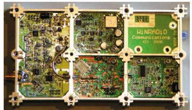
Bild 3: Ein Blick ins Innere des WiNRADiOs, hier die HF-Seite mit der SMA-Buchse auf der linken Seite
