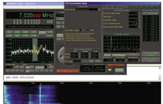
Bild 5: Ausprobieren der variablen ZF-Filter für PSK31
