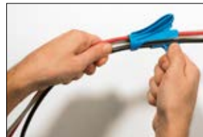
Kabelbündel seitlich in das Aufziehwerkzeug legen.
