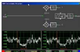
Bild 3: Der Profi-Demodulator zeigt die Arbeitsweise eines Quadraturmischers.
