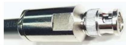
Das vorbereitete Kabelende bis zum Anschlag in das Steckergehäuse einschieben. Mit zwei Maulschlüsseln 16 mm die Spannmutter handfest anziehen. Ein kleiner Spalt zwischen Mutter und Steckergehäuse sollte noch sichtbar sein!
