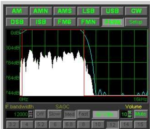
Professional Demodulator mit aktivierter Wide-FM Option u. Audiofilter / variabler Bandpass
