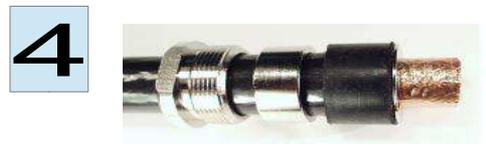
Kupfergeflecht im rechten Winkel hochbiegen. Kontakthülse zwischen Kupferfolie und Geflecht bis zum Anschlag einschieben. Überstehendes Geflecht abschneiden. Gummidichtung bis zur Kontakthülse nach vorne schieben.
